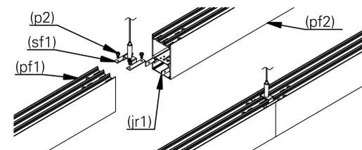
**8.** para instalação linear dos perfis com duas fita led, encaixe o perfil (pf1) no suporte fixo (sf1) e na junção reta (jr1) até a metade e em seguida encaixe o perfil (pf2). aperte os parafusos (p2) para o travamento conforme a imagem acima.
