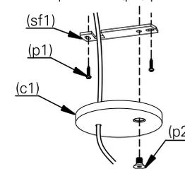
**6.** a luminária após instalada deverá ficar como ilustrado na imagem. ligue na rede elétrica e teste o seu funcionamento.
