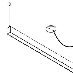
**7.** para instalação linear dos perfis com uma fita led, encaixe o perfil (pf1) no suporte fixo (sf1) e na junção reta (jr1) até a metade e em seguida encaixe o perfil (pf2). aperte os parafusos (p2) para o travamento conforme a imagem acima.
