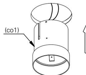
5. passe as grapas de fixação (gf1) pelo centro do corpo (co1) conforme a imagem (a) e encaixe na fresta conforme a imagem (b) faceando o corpo com o gesso.
