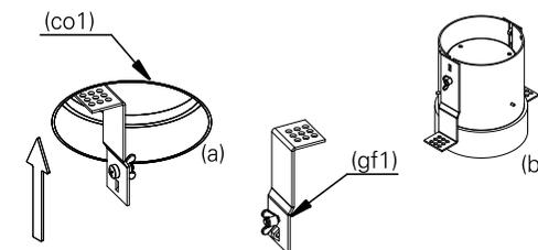
6. utilize os parafusos (p1) para fixar o corpo (co1) e de o acabamento no forro com gesso, não deixando o parafuso aparente. espere a secagem do gesso para prosseguir a próxima etapa.
