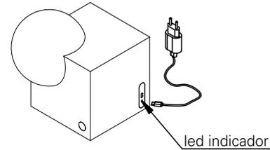
2. após a carga completa da luminária, desconecte o carregador (c1).
