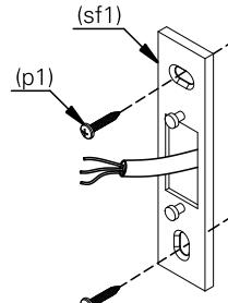
2. em caso de driver em ponto remoto, faça a ligação respeitando a distância até 5m entre a luminária (lu1) e o driver, para não acarretar no mal funcionamento e isole os fios separadamente com fita isolante e autofusão.
