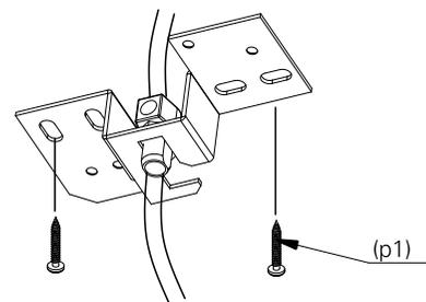
**4.** utilizando a chave allen, solte o cabo do trava cabo (tc1) e ajuste a altura da luminária. prenda o cabo com a chave allen e corte o excedente, deixando 10cm de sobra.
