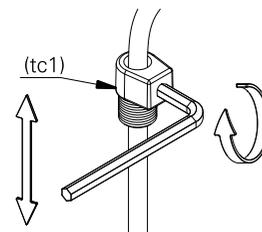
**5.** encaixe novamente o trava cabo (tc1) no suporte de fixação (sf1). certifique-se de que o parafuso esteja bem apertado.
