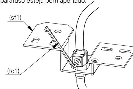
**6.** encaixe a canopla (c1) no suporte de fixação (sf1) e rosqueie a porca de arremate (par1).
