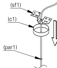
**2.** desencaixe o trava cabo (tc1) do suporte de fixação (sf1).
