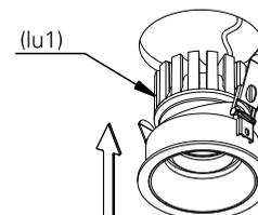
**5.** para orientar o fecho de luz, mova a luminária (lu1) para direção e rotação conforme indicado.
