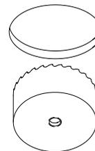
**2.** aloje o driver sobre o forro. faça a conexão entre os cabos condutores da luminária e os fios da rede elétrica, utilize conectores apropriados para garantir o contato firme e seguro. caso necessário isole-os separadamente com fita isolante.
