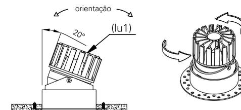
**8.** a luminária após instalada deverá ficar como ilustrado na imagem. ligue a rede elétrica e teste o seu funcionamento.
