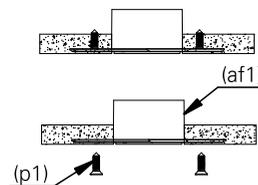
**5.** aloje o driver sobre o forro. faça a conexão entre os cabos condutores da luminária e os fios da rede elétrica, utilize conectores apropriados para garantir o contato firme e seguro. caso necessário isole-os separadamente com fita isolante.
