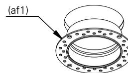
**4.** utilize os parafusos (p1) para fixar o aro de fixação (af1), em seguida faça o acabamento no forro cobrindo-o com a massa de acabamento, não deixando o parafuso aparente.
