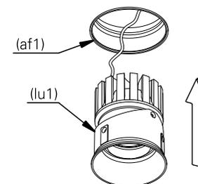
**7.** para orientar o fecho de luz, mova a luminária (lu1) para direção e rotação conforme indicado.
