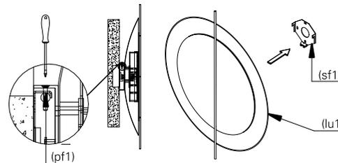
4. a luminária após instalada deverá ficar como ilustrado na imagem. ligue a rede elétrica e teste o seu funcionamento.
